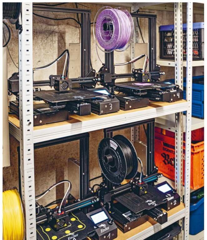
3D-Drucker werden zur Produktion des «AryFix» eingesetzt.
